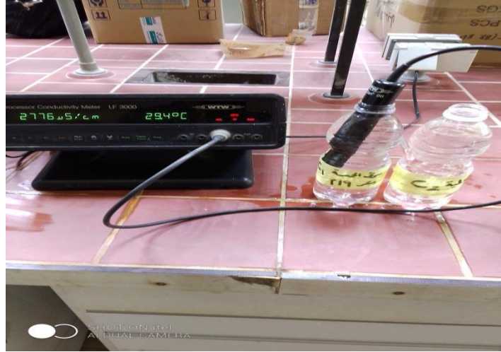
شكل (2) جهاز تقدير قيمة تركيز (pH Conductivity Meter LF 3000)
