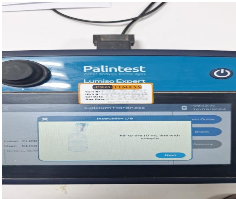
شكل (3) إجهاز تقدير تركيز كاتيون الكالسيوم ( Palintest Lumiso Expert )
